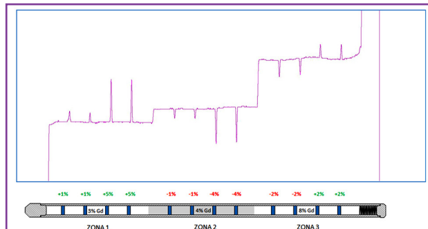
Figura 5. Croquis de barra patrón con pastillas desviadas de Gadolinio (abajo) y señal correspondiente del sensor de Gadolinio (arriba).
