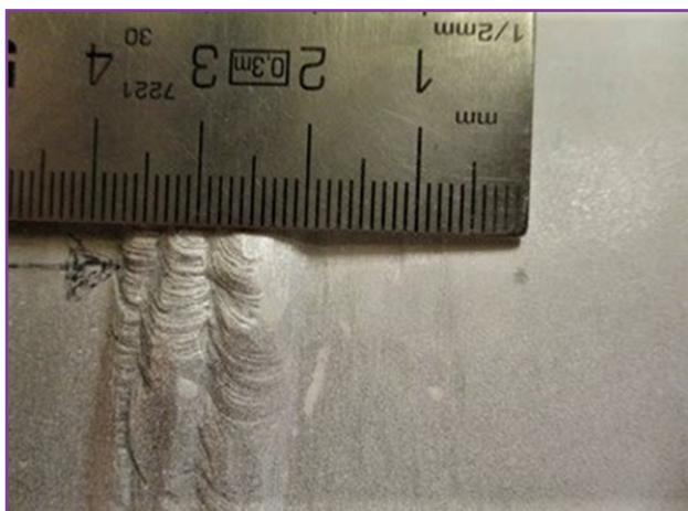
Figura 2. Detalle de la localización del poro con respecto a la soldadura.
