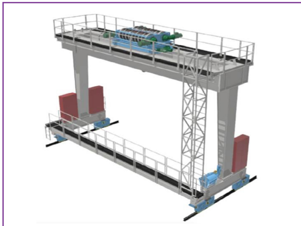
Figura 4. Detalle Grúa temporal 20/2 Tn.
