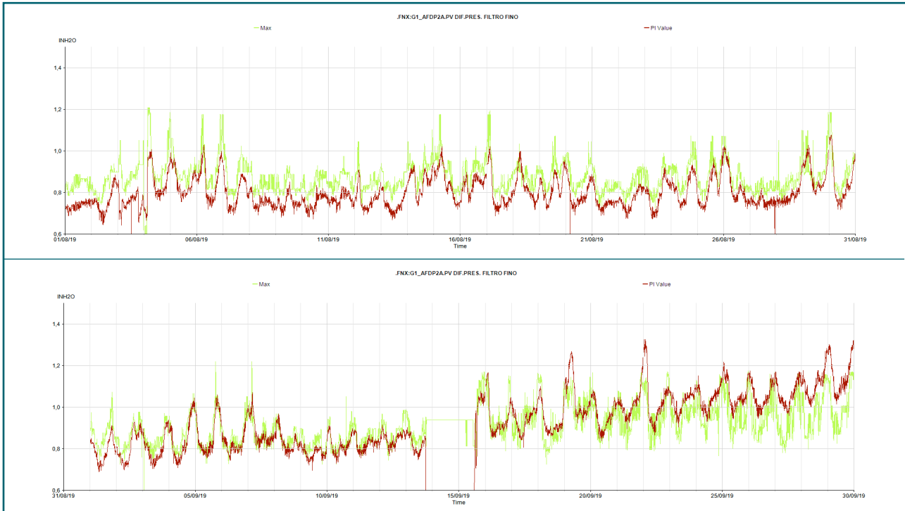
Figura 8. Evolución en dos meses consecutivos de la deltaP en un filtro de toma de aire.
