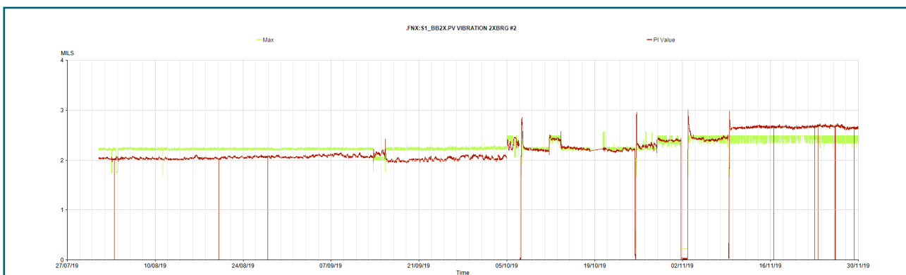
Figura 9. Evolución en las vibraciones en los cojinetes de una bomba de agua de alimentación.
