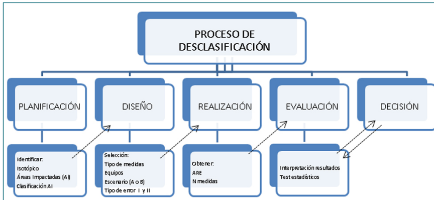
Figura 1. Esquema general del proceso de desclasificación de acuerdo con MARSSIM [4].
