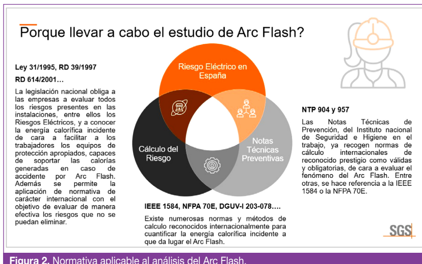
Figura 2. Normativa aplicable al análisis del Arc Flash.
