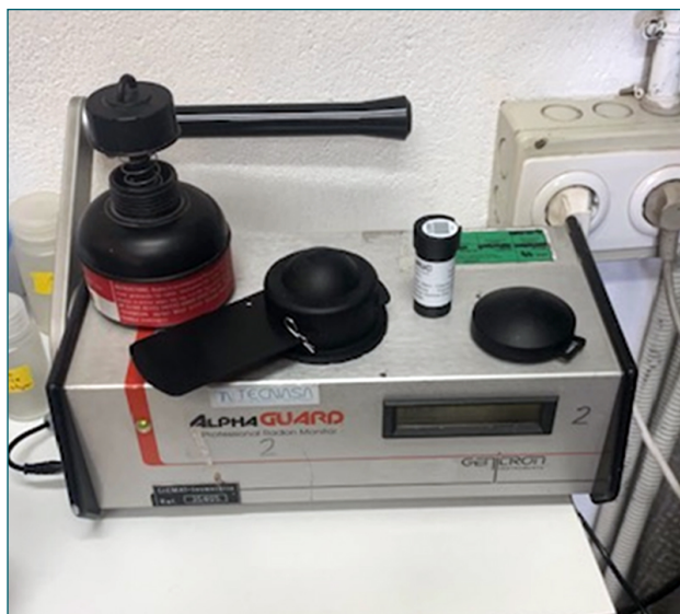
Figura 1. Detector de medida de radón en continuo (Alpha Guard), detectores E-PERM® y detectores de trazas (CR39 y LR115).
