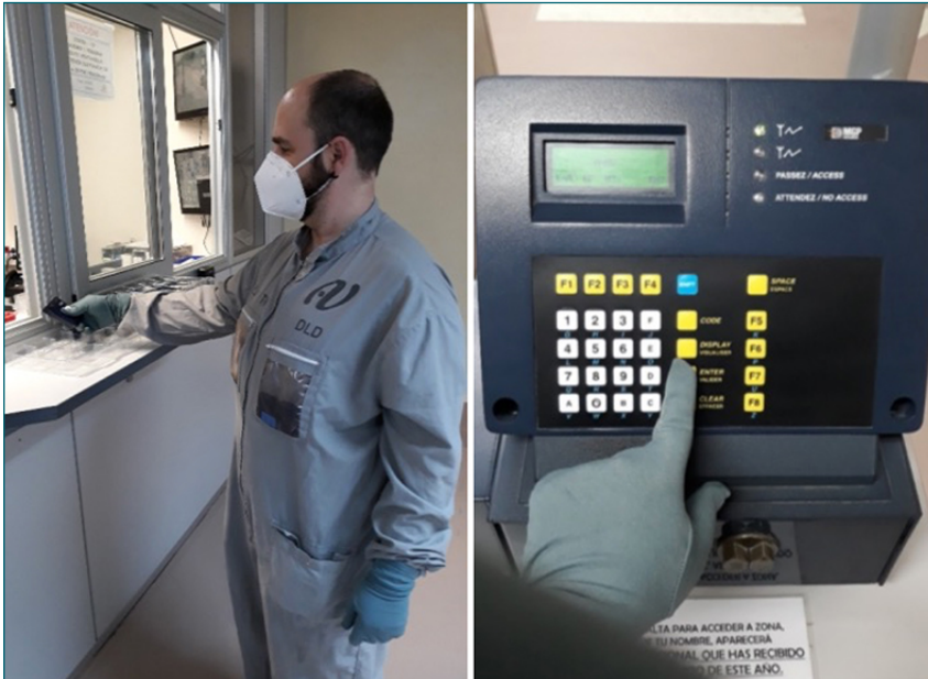
Figura 3. Proceso de recogida de DLD en la ventanilla de PR y acceso dosimétrico en CN Vandellòs II.
