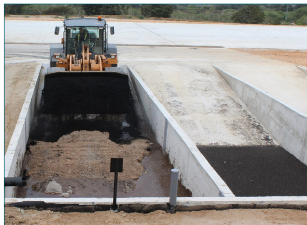
Figura 7. Proceso de comienzo de mezclado de componentes para la fabricación de tecnosol.
