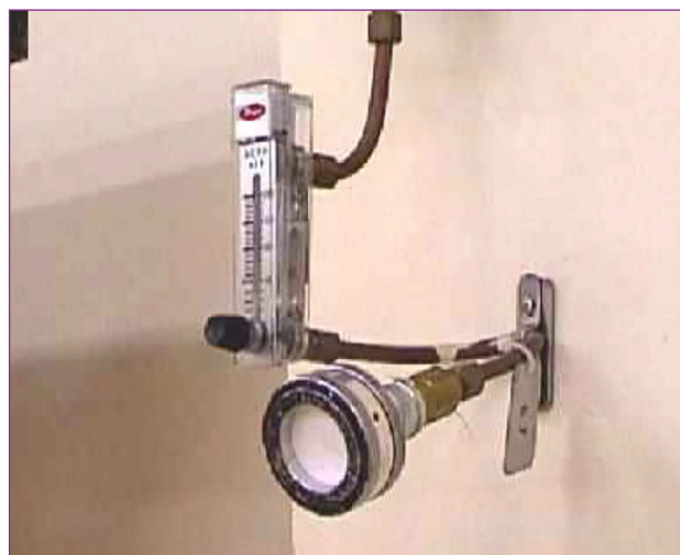
Figura 1. Tomamuestras formado por caudalímetros-portafiltros conectados a un sistema de aspiración.
