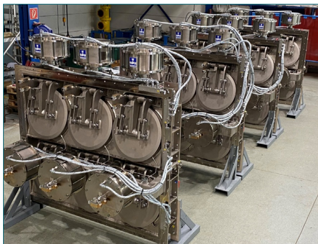
Figura 2. Nuevas compuertas de aislamiento del Edificio del Anillo.
