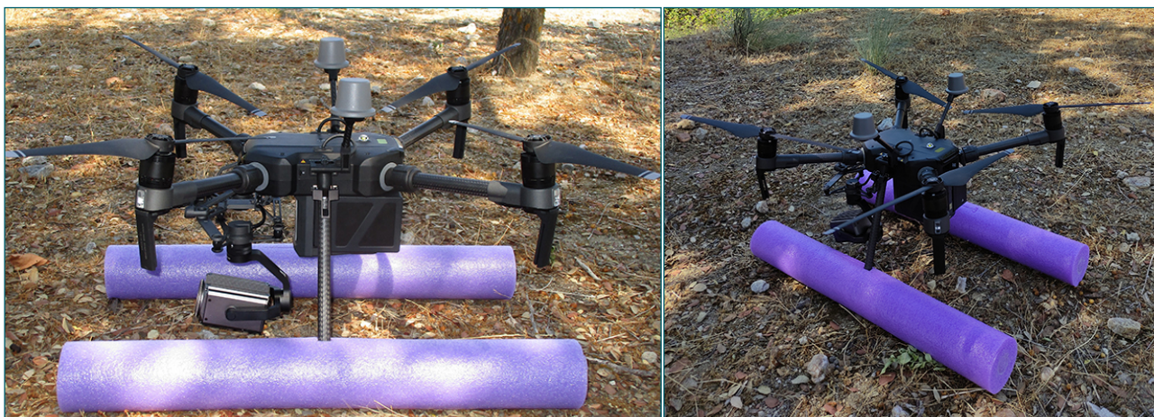
Figuras 1 y 2. RPAS preparado para despegue con sistema de flotación incorporado.
