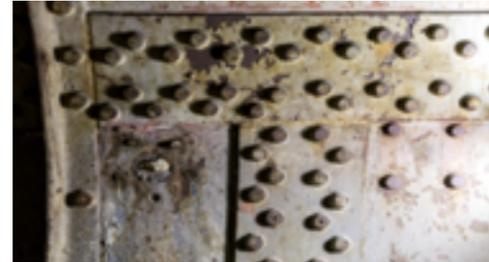
Foto 8. Interior del submarino Peral donde se aprecia el roblonado de chapas.
