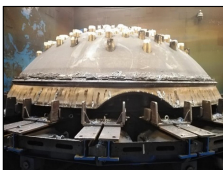
Corte del Calotte: corte de piezas en figuras tipo cuadrados o rectángulos
