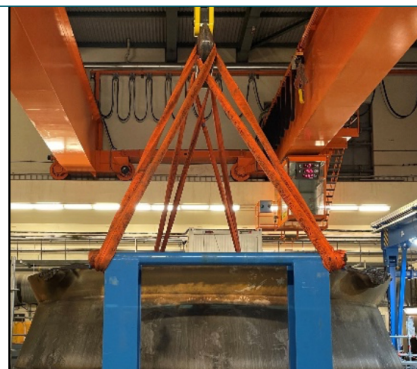
Retirada del Calotte para realizar el volteo
