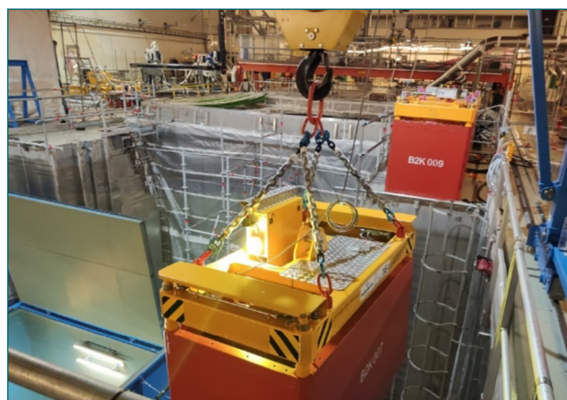
Figura 5. Izado de un contenedor Kokill ya relleno.
