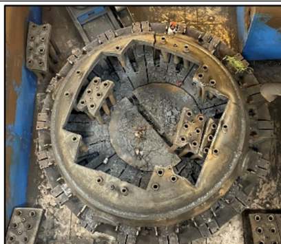
Corte del Calotte: corte de piezas en figuras tipo cuadrados o rectángulos
