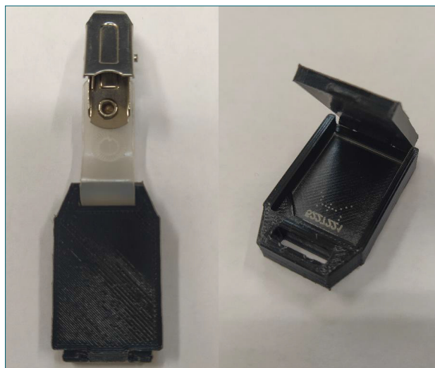
Figura 3. Prototipo del chasis diseñado y construido en el Ciemat.
