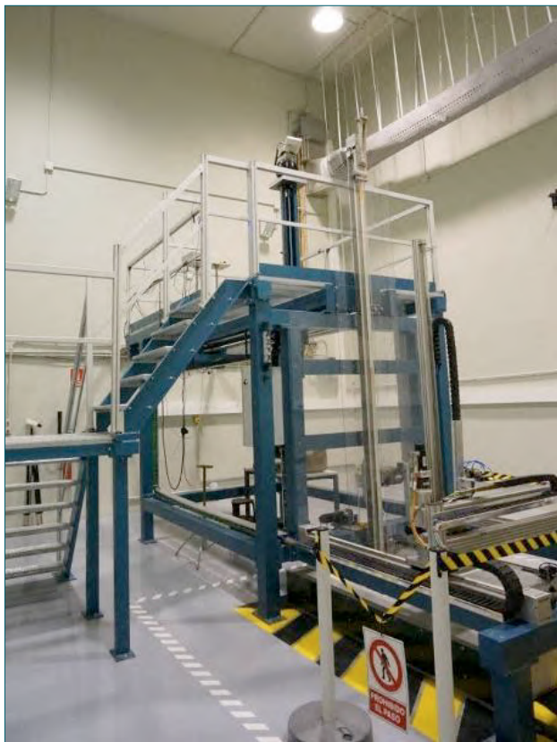
Figura 1. Panorámica de la Sala de Irradiación del LPN con la bancada y el sistema de manipulación de fuentes neutrónicas. Calibración de monitor neutrónico con fuente de Am-Be.
