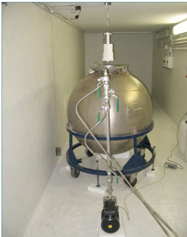
Figura 2. Baño de Mn instalado en el Instituto Nacional de Metrología de las Radiaciones Ionizante de ENEA, la Agencia Nacional para la nueva tecnología, la energía y el desarrollo económico sostenible (Italia), similar al previsto en el Laboratorio de Patrones Neutrónicos.
