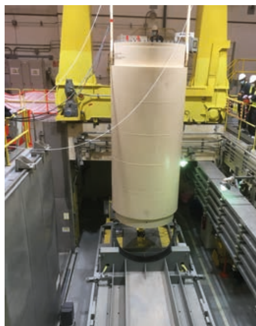
Proceso de carga de un contenedor de combustible gastado en el edificio de combustible para su traslado al ATI
