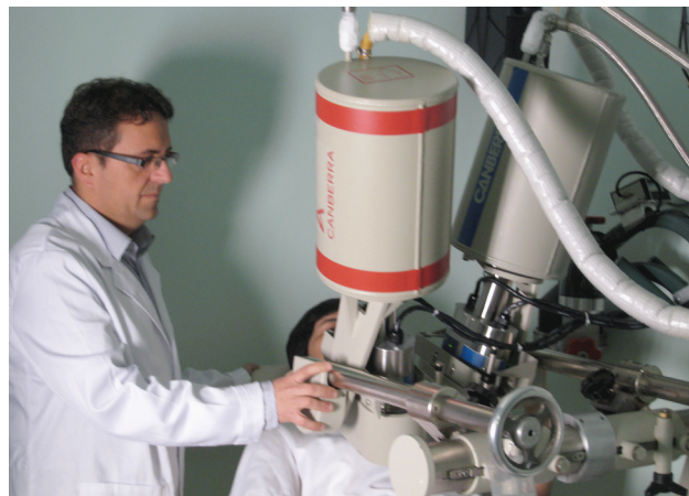
Figura 6. Medida in vivo para la determinación de actínidos en pulmón. CRC-Ciemat.
