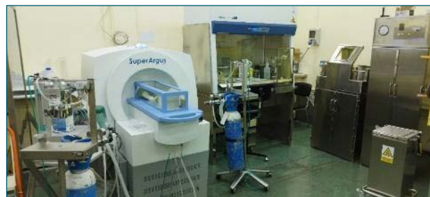
Figura 4. Imagen del laboratorio de la Unidad de Aplicaciones Médicas de las Radiaciones Ionizantes. De izquierda a derecha, sistema de anestesia, equipo microPET/CT, cabina de flujo laminar con pantalla de cristal plomado, pantalla plomada para extracción de dosis y armario y papelería blindados.
