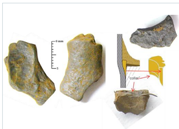
Figura 11. Detalle de lodos depositados en la placa de tubos del generador de vapor de CC.NN españolas produciendo "denting" en los tubos de la aleación 800.
