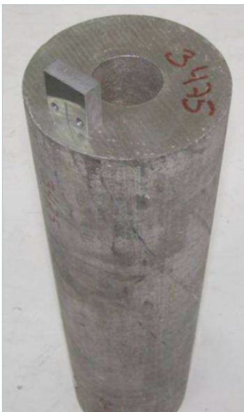
Figura 7. Probetas obtenidas de CRDM tubo, aleación 690.
