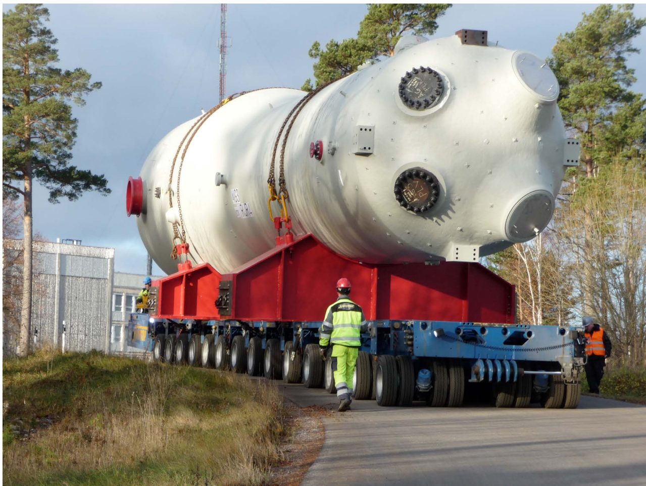
Figura 2. Transporte de un Generador de Vapor, dentro las instalaciones de Cyclife en Suecia. (Fotografía cortesía de Cyclife)
