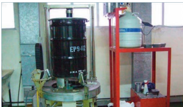
Equipo de caracterización radiológica no destructiva de bidones de residuos radiactivos de baja y media actividad.
