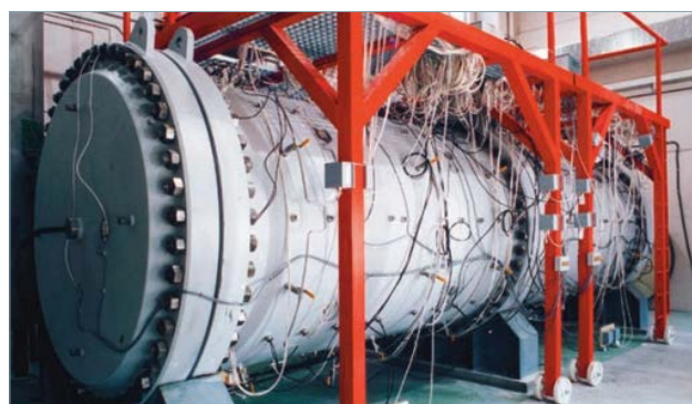
Ensayo de barreras de arcilla para el AGP.
