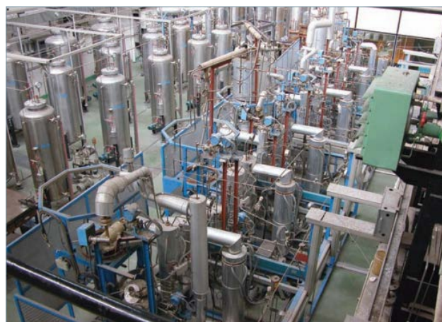
Planta de ensayo de materiales de vasija para alargamiento de vida.
