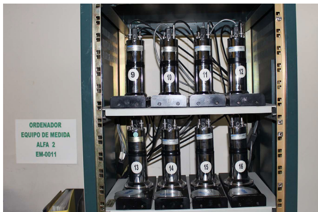
Contador de centelleo sólido de ZnS(Ag) para la determinación del índice de actividad alfa total.
