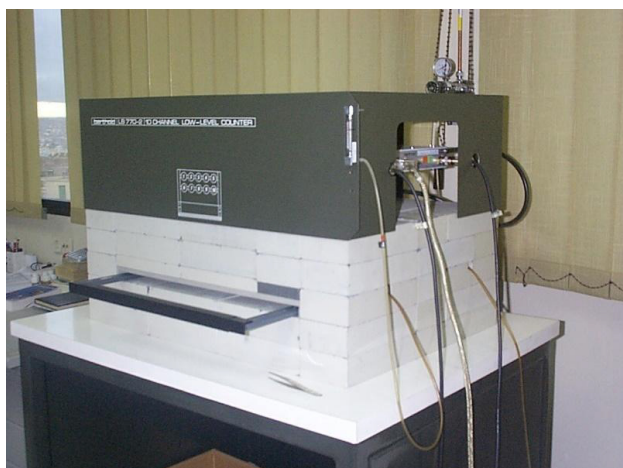
Contador proporcional de flujo continuo de gas para la determinación del índice de actividad beta total.
