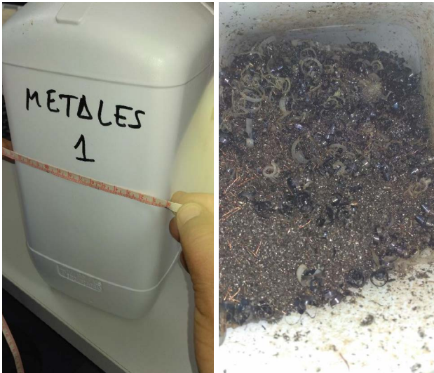
Figura 5. Muestra de viruta de chatarra enviada al laboratorio.
