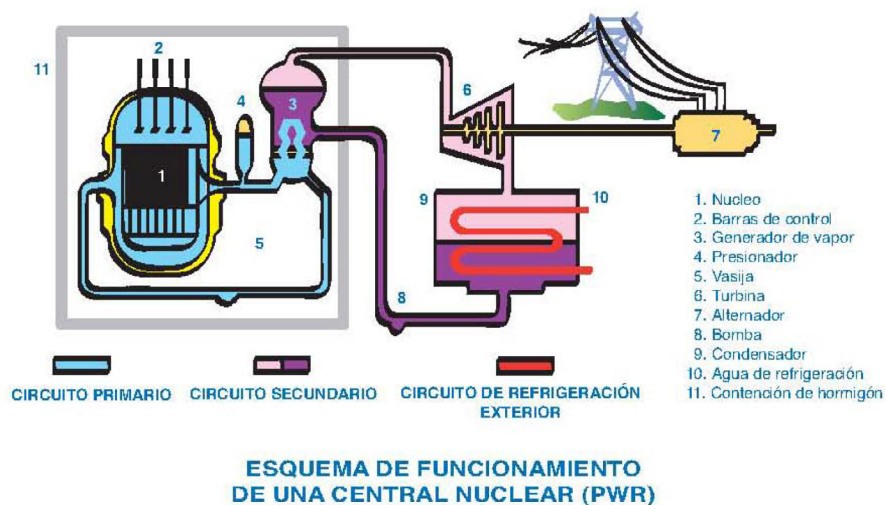
Figura 3. Esquema funcionamiento de una central nuclear (PWR). Fuente: CSN
