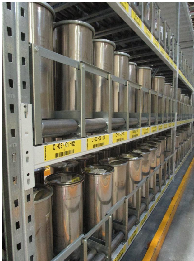
Figura 4. Bidones de \text{UO}_2 que cumplen el parámetro de moderación almacenados en estanterías. La restricción geométrica es mucho menor.
