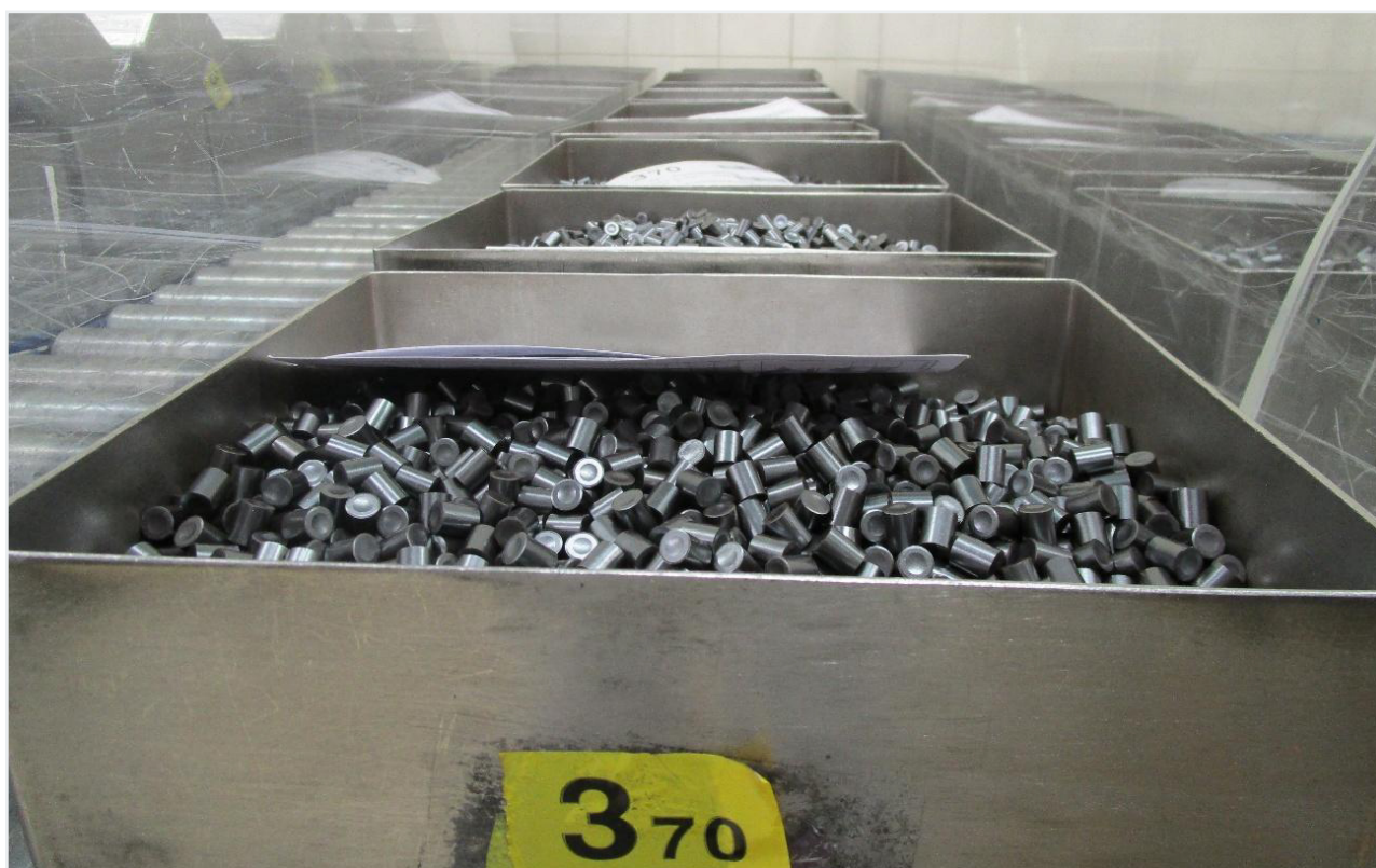
Figura 2. Acumulación de pastillas de \text{UO}_2 sinterizadas. Control del parámetro de geometría.
