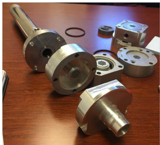
Figura 6. Prototipo de dispositivo mejorado para la producción en blancos gaseosos y sólidos.
