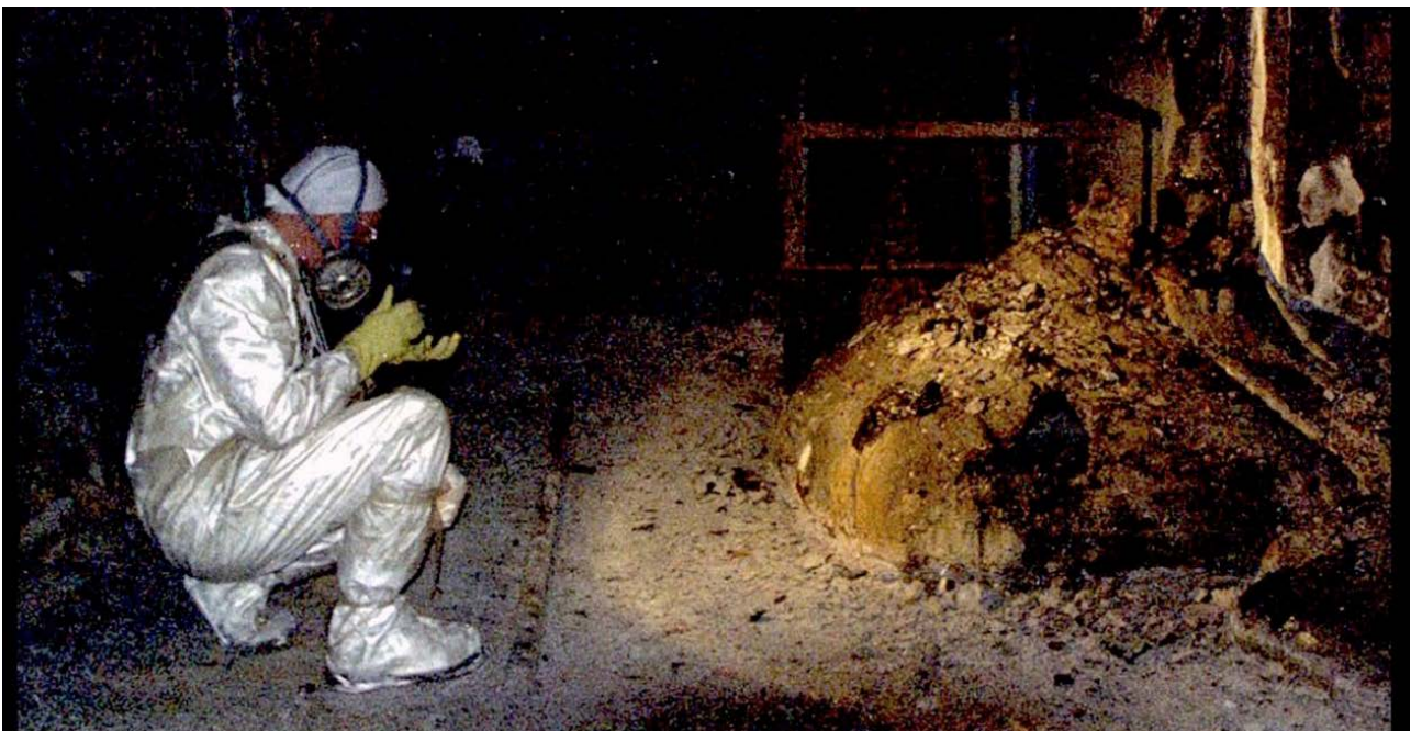
Figura 5. Materiales formados durante la fusión del núcleo del reactor de Chernóbil. Fuente: © Universal History Archive/Universal Images Group/Getty Images.
