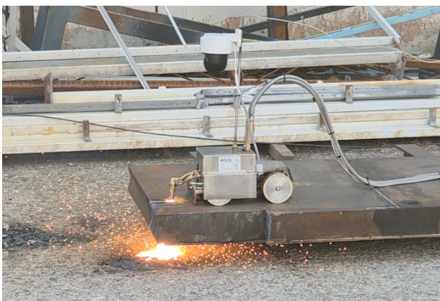
Figura 8. ROV de oxicorte. Prototipo en pruebas. Fuente: Westinghouse Electric Company.
