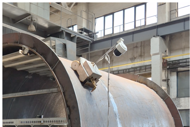
Figura 8. ROV de oxicorte. Prototipo en pruebas. Fuente: Westinghouse Electric Company.
