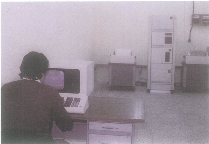
C. N. Vandellós II. Equipo de proceso de datos para preparación y control de canalizaciones, tendido y conexionado.
