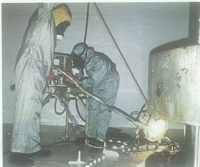
Ejecución ISI de soldaduras brida-vasija en C. N. José Cabrera con dispositivo accionado a distancia.
