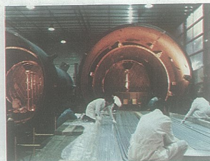
— Generador de vapor — Montaje de las haces tubulares en la fábrica constructora en España.
