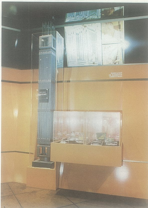
La exposición del Centro de Información incluye maquetas a escala de distintos componentes que participan en la generación de electricidad a partir del uranio. En la foto, una maqueta de un elemento combustible, y, a su derecha, una vitrina con mineral y concentrados de uranio.
