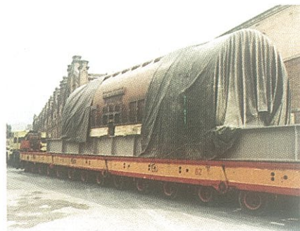
Transporte del estator del Alternador de 438 TM a Alemania para una prueba final. El Estator fue construido enteramente en España.
