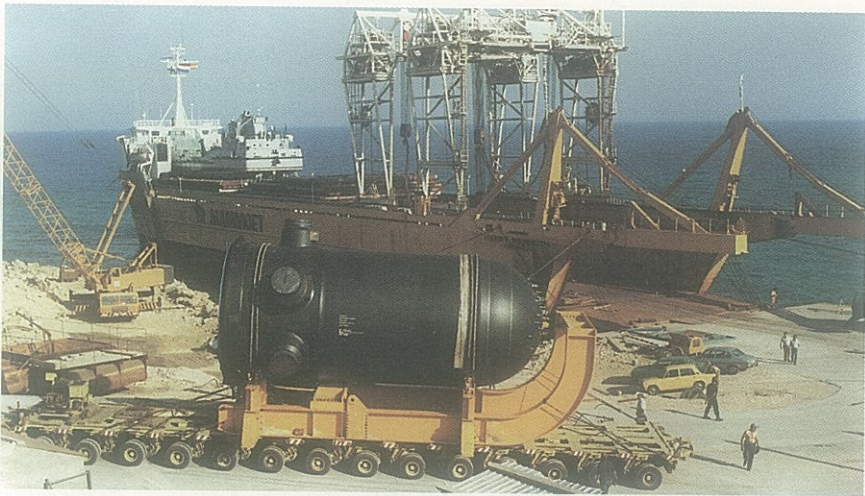
Transporte de la Vasija del Reactor (junio 1984)
