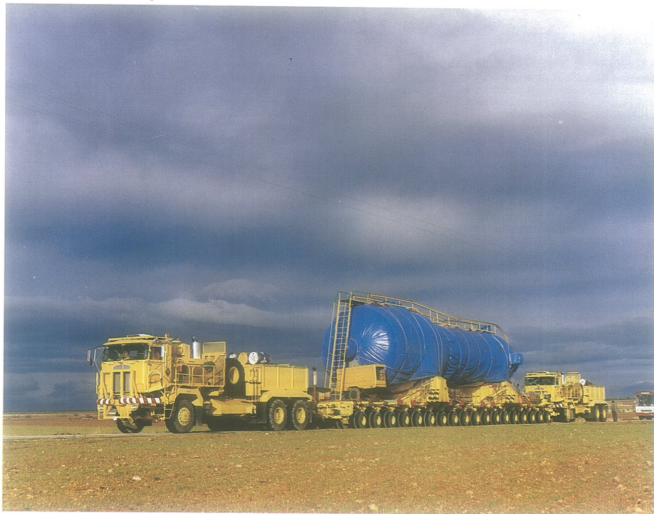
Transporte de un generador de vapor.
