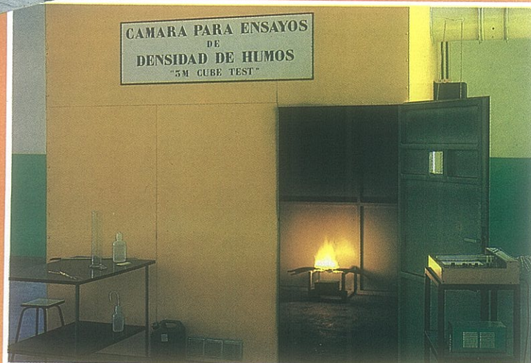
Cámara "3M cube test" de los laboratorios Pirelli para el control de los humos.
