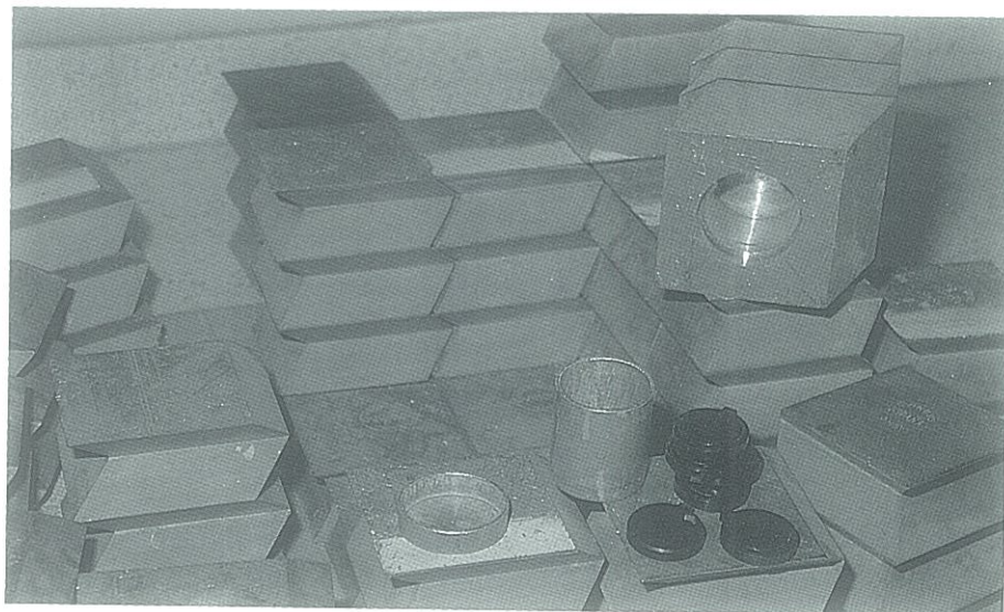
F II Blindaje desmontado mostrando el botecito para los dosímetros de control
