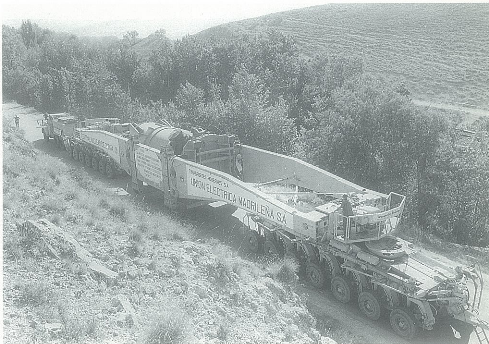
Transporte por la carretera N-400 de la vasija del reactor. Agosto 1966
