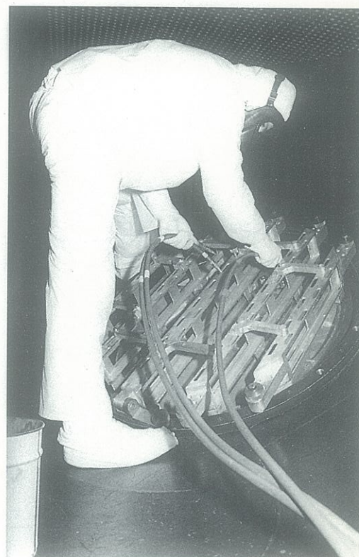
F II Brida Modular de Obturación Neumática. Instalación en maqueta 1:1 de generador de vapor
