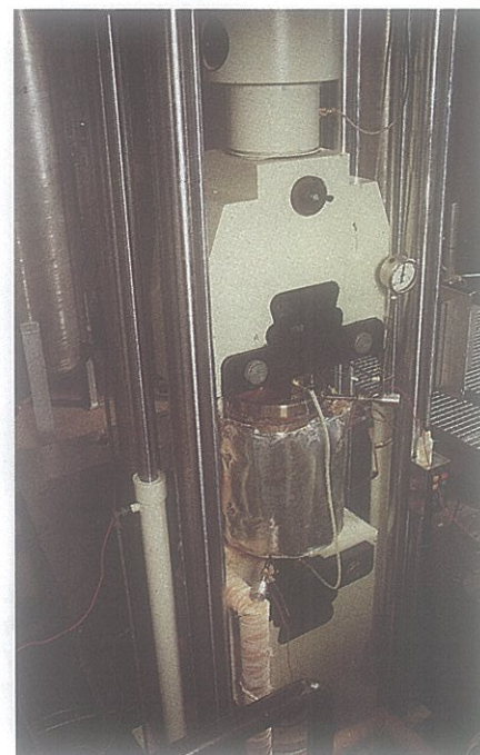
F II Dispositivo para la generación de grietas por corrosión intergranular
