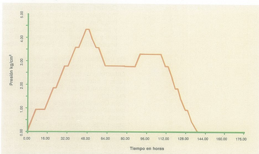
F II Variación de la presión en el interior del edificio de contención, en función del tiempo, en las pruebas de fugas e integridad de dicho edificio
