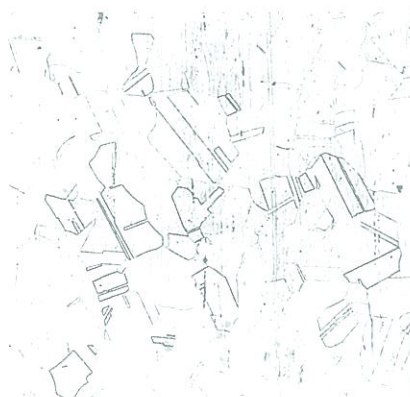
n/s 2. Rotura en encastre. Austenita 200X
