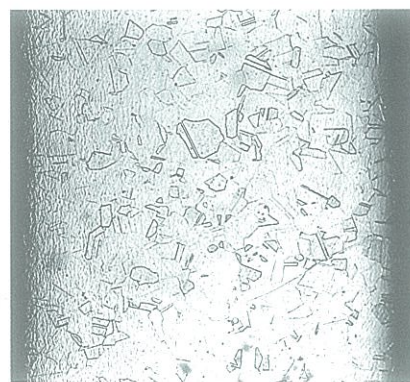
n/s 3.—Impacto líquido de drenaje. Austenita 200X
