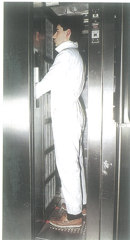
Arcos de detección. Salida de zona controlada.
