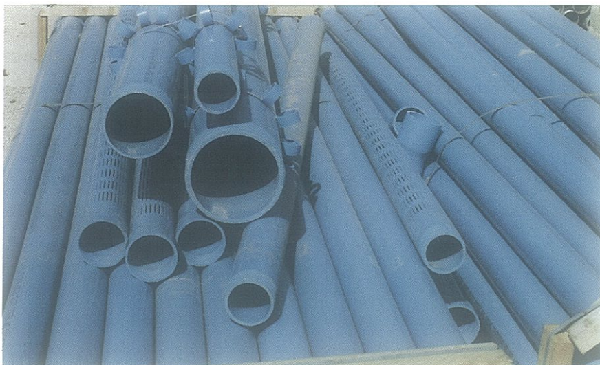
F V Aspecto de las tuberías de PVC empleadas en los piezómetros. Un haz, con centradores, en la parte superior.
