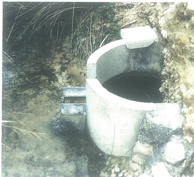
F I Vista de uno de los manantiales una vez preparado para la medición de caudales y toma de muestras
