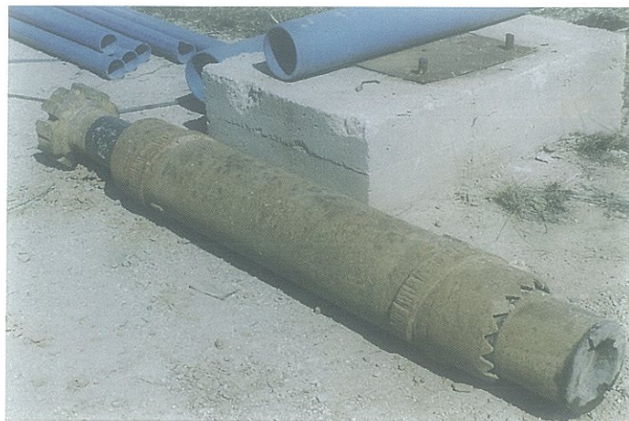
F III El martillo perforador. En el extremo más alejado está el útil de corte, al que sigue el bloque distribuidor-estabilizador.
