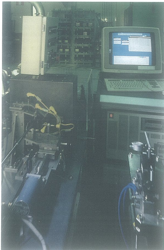
Equipo de Ultrasonidos. Control de Calidad de Soldaduras. (Fábrica de Juzbado).
