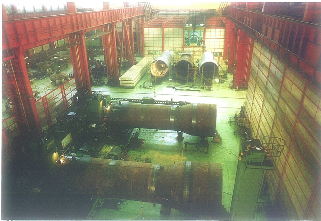
Taladrado placas tubo, como SA's 30. Al fondo, área limpia de generadores de vapor.
