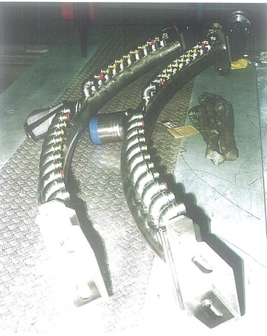
Sustitución de rociadores de agua de alimentación en la vasija de una central BWR
