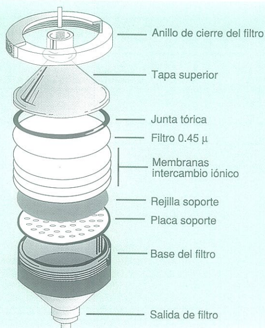
F II - Detalle de la unidad de filtrado
