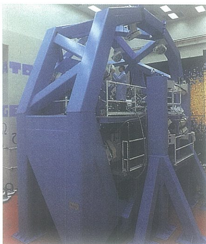
La cámara anticátodo constituye el núcleo de una estructura masiva que sostiene los espejos para guiar los rayos láser.
